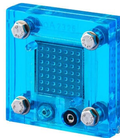
燃料電池キット(市販) 化学生命工学実験第二で使用
