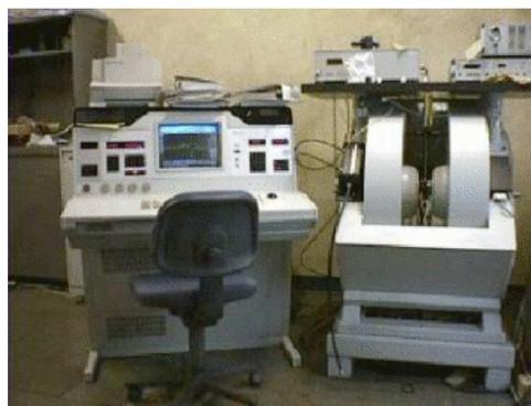
電子(Electron) のスピン (Spin; Paramagnetic spin) の共鳴 (Resonance) を調べる装置。不対電子は自転に例えられる小さな磁気モーメントをもち、磁場に置かれると電磁波で揺さぶられる。特徴的な周波数のエネルギーを吸収・放出する様子はブランコの振りと似ている。エネルギー準位の幅はマイクロ波領域の電磁波に相当する。
