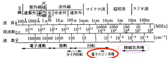
図 1.1 分子による電磁波の吸収
