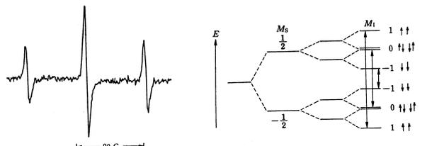
図 1.19 等価な2個の  $^1H$  核による超微細構造
